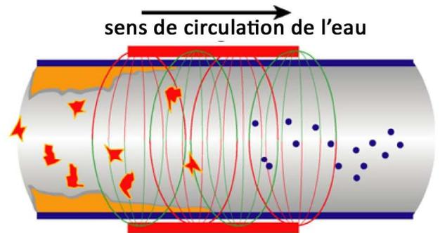
Lors de la transformation du calcite en aragonite on assiste à un changement de phase, ou la structure du calcite disparaît et ou apparaissent de nouveaux petits cristaux d'aragonite. Ces nouveaux cristaux ne peuvent plus se fixer sur les tuyaux et les cuves (des ballons d'eau chaude par ex.). Même des dépôts existants de calcaire et de rouille sont décollés, en partie dissous, et entraînés au fil de l'eau.
