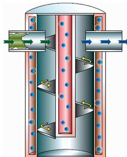
Grâce à la double spirale intégrée, on obtient un tourbillonnement idéal
