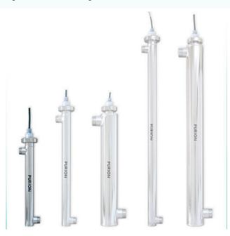
L'installation PURION 1000 est livrée en acier électropoli. Elle est à utiliser pour la stérilisation de l'eau potable pour une capacité allant jusqu'à 1.000 l/h de capacité et pour une transmission (ou diffusion aussi) de l'eau d'au moins 90% par cm. Les piscines et les étangs à poissons jusqu'à une contenance de 10.000 l peuvent être entre autre un terrain d'application.
